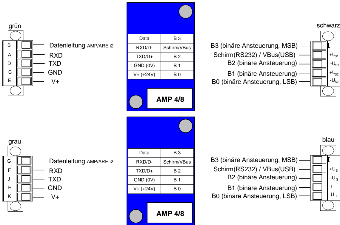
Abbildung 4: Pinbelegung der SAB-Steckerleiste
